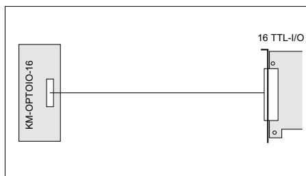
16 isol. Eingänge, 16 isol. Ausgänge 150mA
