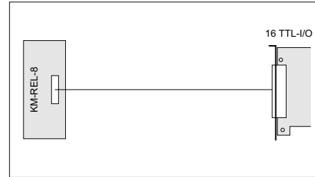
8 isol. Ausgänge 5A
